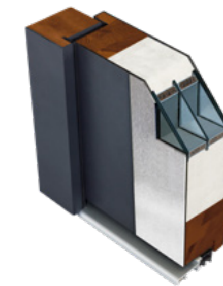
PRZEKRÓJ SKRZYDŁA Z OŚCIEŻNICĄ ENERGO
